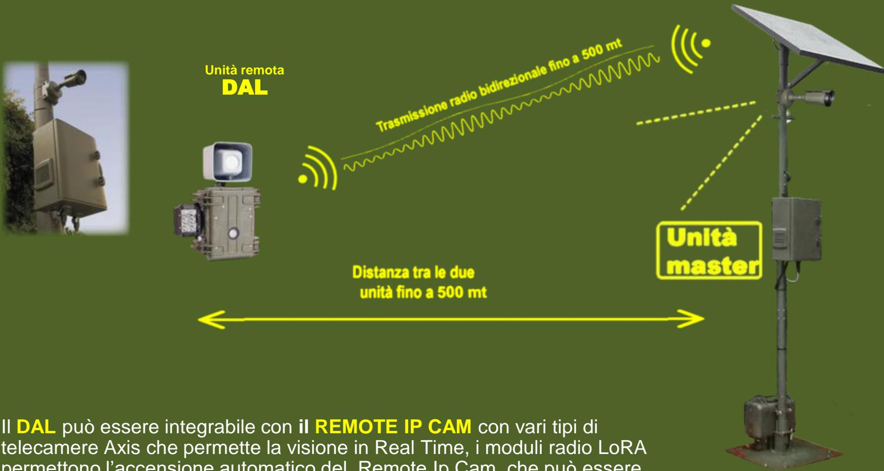
Il **DAL** può essere integrabile con il **REMOTE IP CAM** con vari tipi di telecamere Axis che permette la visione in Real Time, i moduli radio LoRA permettono l'accensione automatico del Remote Ip Cam che può essere alimentato con alimentazione ibrida (corrente di rete + pannelli solari) e relative batterie separate.
