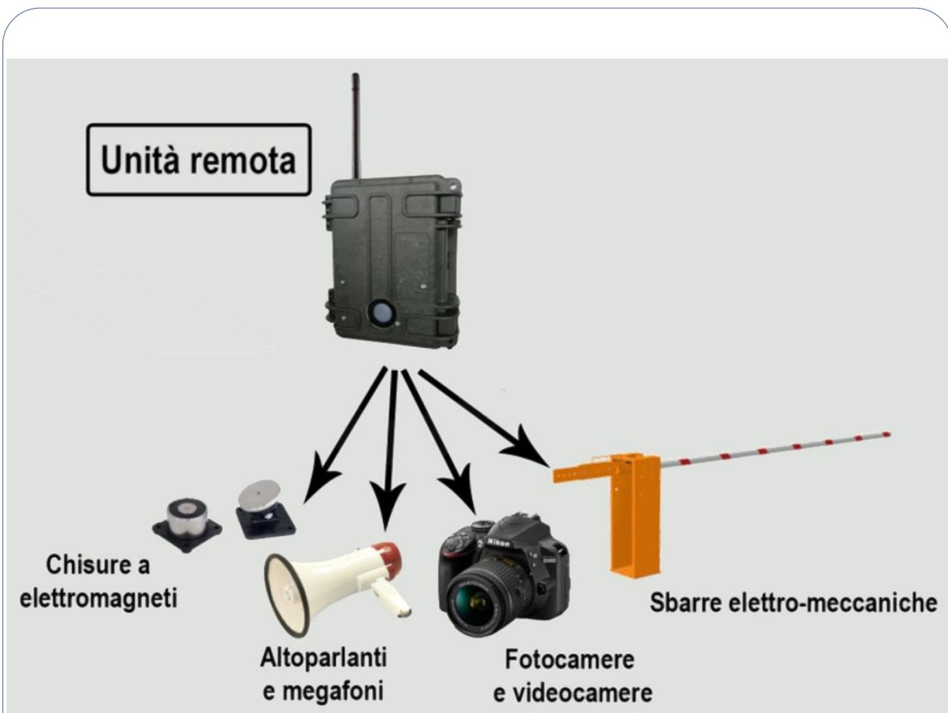
In questo scenario è presente la sola Unità REMOTA alloggiata in un case/valigia IP68 nel quale risiede una batteria 12V per l'alimentazione. In opzione può essere aggiunto un pannello solare per ricarica della batteria e aumentando l'autonomia per un uso prolungato.
