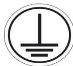
Si ricorda di collegare l'armadio ad una terra efficace con un cavo di sezione adeguata (4-6 mm.) con la minor lunghezza possibile.
