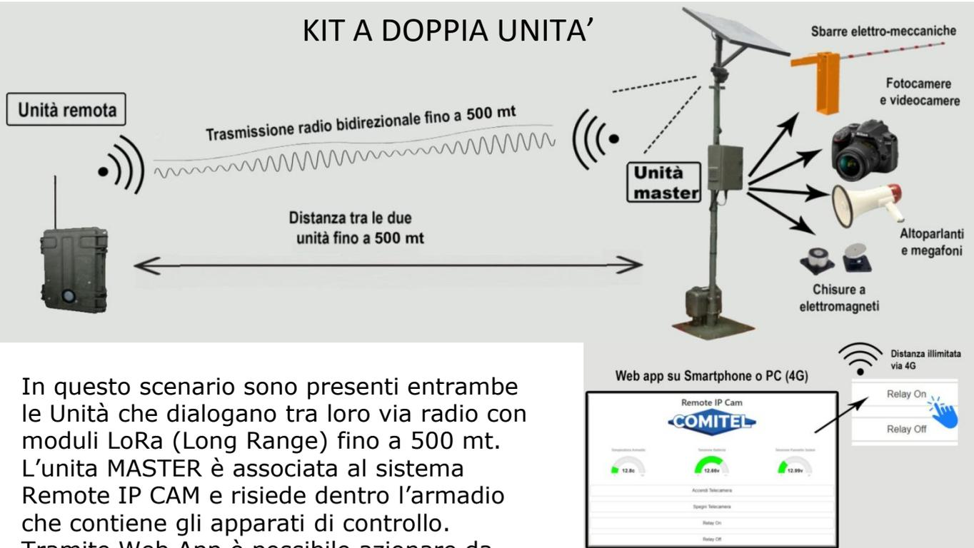
In questo scenario sono presenti entrambe le Unità che dialogano tra loro via radio con moduli LoRa (Long Range) fino a 500 mt. L'unità MASTER è associata al sistema Remote IP CAM e risiede dentro l'armadio che contiene gli apparati di controllo. Tramite Web App è possibile azionare da remoto i comandi a distanza.
